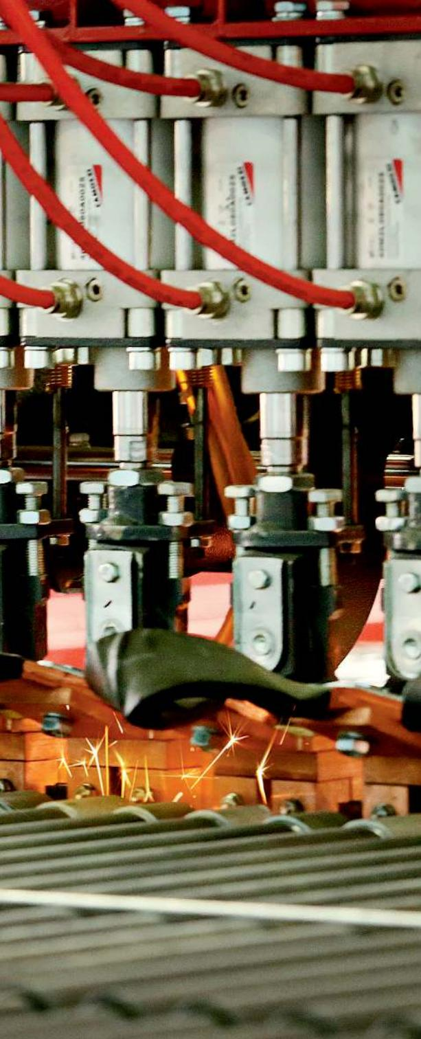
«ГРАНЗА» - это современное автоматизированное производство сетчатых 3D панелей ограждения различной конфигурации. Панели изготавливаются из стального оцинкованного прутка методом точечной сварки, 3D гиб усиливает прочность конструкции и делает панель самонесущей. На сегодняшний день, это наиболее оптимальный вариант обустройства ограждений различного назначения с точки зрения стоимости, долговечности, скорости монтажа и внешнего вида.
